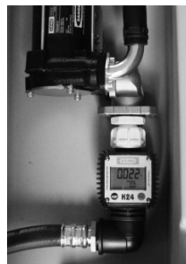
Foto 6.2.2: contatore digitale per serbatoi da 4301, 4601 e 6001
