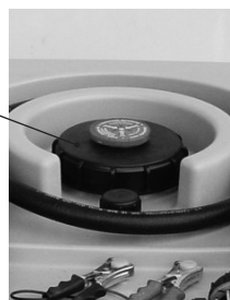
Figure 5.4.2 : Ouverture de remplissage cuve 460l / cuve 600l
