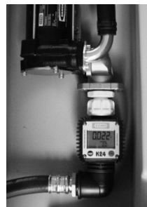
Kuva 6.2.2 Läpivirtauslaskuri - 430l:n / 460l:n / 600l:n säiliö
