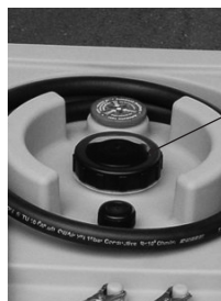
Foto 5.4.1: apertura di riempimento serbatoi da 125l / 430l
