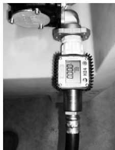
Foto 6.2.1: contatore digitale per serbatoi da 1251 e 2001
