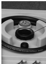
Afbeelding 5.4.1: Vulopening 125 l/430 I-tank
