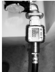
Bild 6.2.1: Durchflusszähler für 1251 / 2001-Tank
