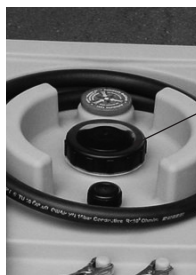
Figure 5.4.1 : Ouverture de remplissage cuves 125l / 430l
