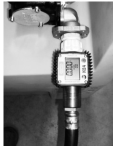
Bild 6.2.1: Flödesmätare för 1251 / 2001 tank
