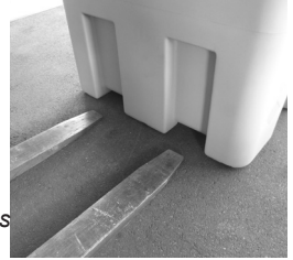
Chargement à l'aide d'un chariot élévateur
